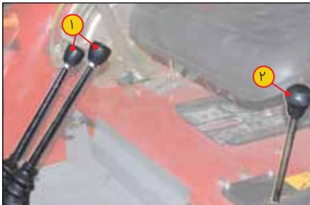
شکل ۱: اهرم‌های دنده (۱) و اهرم (۲) P.T.O
