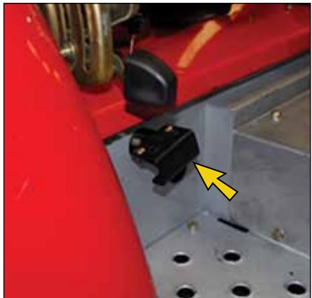
شکل ۴: پدال قفل دیفرانسیل
