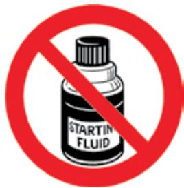
شکل ۱۳: از مایع کمک استارت استفاده نکنید
