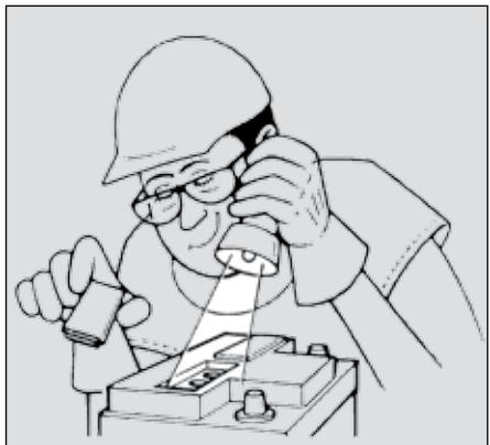
شکل ۵۸: کنترل سطح آب باتری
