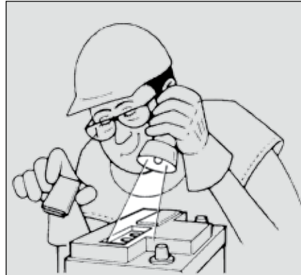
شکل ۱۲: کنترل سطح آب باتری
